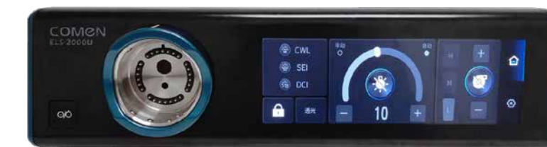
ИСТОЧНИК СВЕТА: ELS-2000U 4 светодиода высокой яркости 20 000 часов непрерывной работы До 1400 лм (допуск -10%, без верхнего предела) Цветовая температура: 5000K-7000K; CRI≥90
